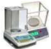
Inoltre, l'oggetto della misura deve trovarsi a temperatura ambiente, affinché non sussistano correnti convettive interne al recipiente, che possano dare una misura errata. Una precisione simile viene raggiunta mantenendo costante il carico sul bilanciante e sottraendo masse dallo stesso lato del peso incognito, invece che aumentarle.
